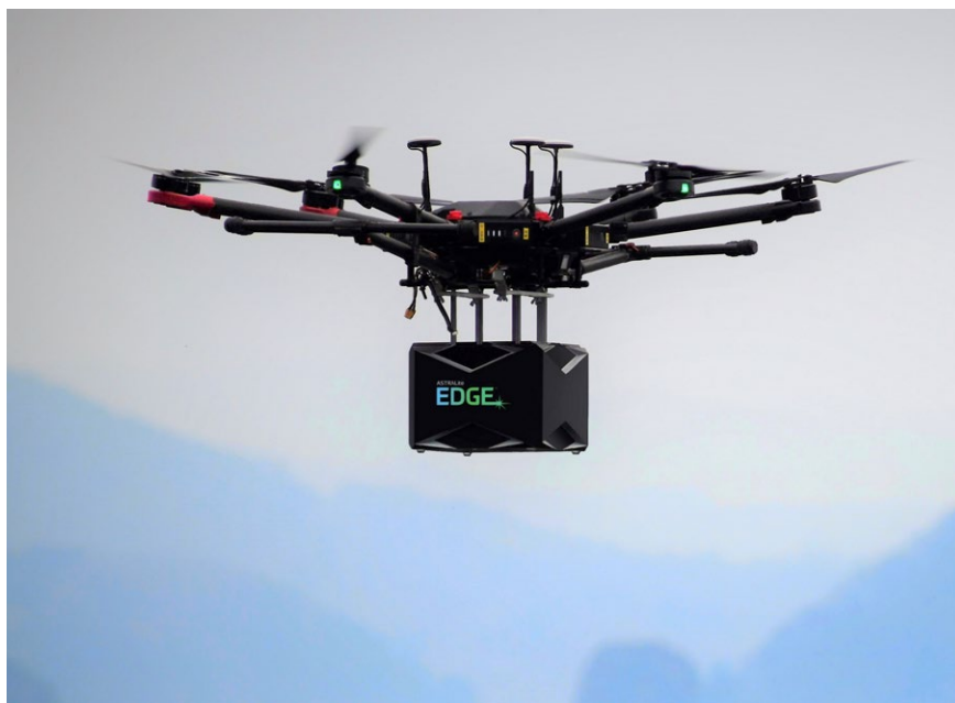
Figure 1: ASTRALiTe EDGE lidar sensor flying on a hexacopter sUAS.
